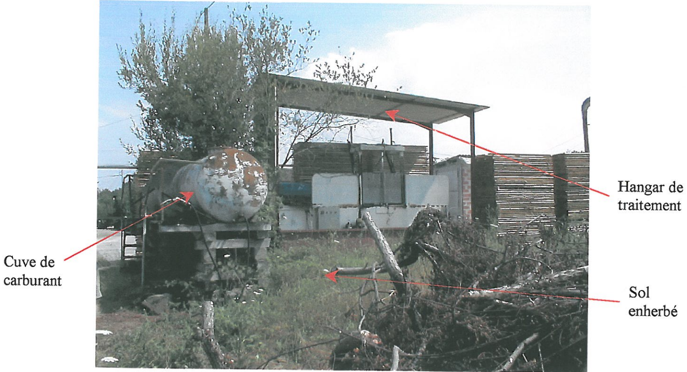
Photo 1 : installation de trempage du bois et stockage de carburant
